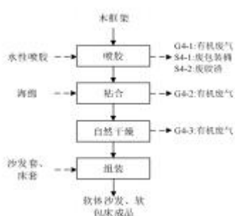
图 1-4 总组装工艺流程图
