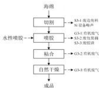
图 1-3 海绵成品生产工艺流程图
