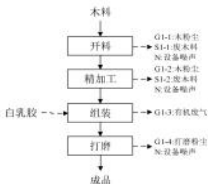
图 1-1 木框架生产工艺流程图
